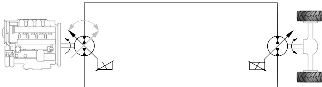
Bild 2: Hydrostatischer Fahrtrieb in der Grundstruktur
