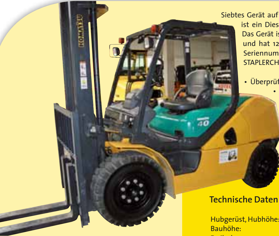
Moderner 4-t-Dieselstapler aus japanischer Produktion, hier mit einem Duplexmast für 4.500 mm Hubhöhe.
